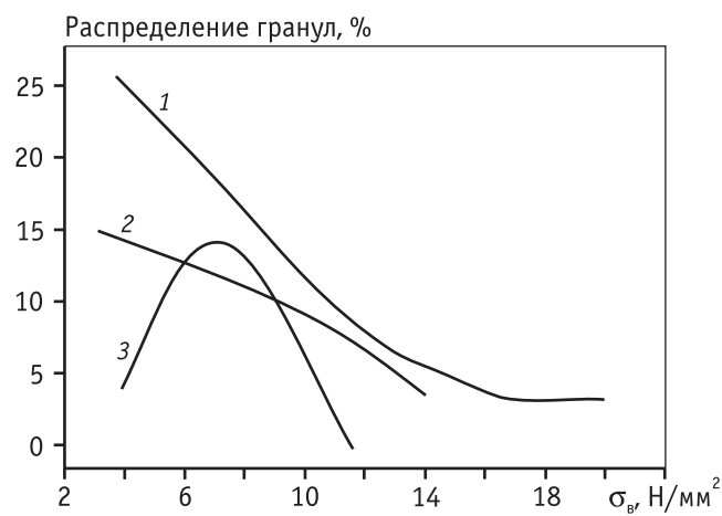
Рис. 2. Кривые распределения гранул носителя ИК-27-25 по прочности на раздавливание, средняя прочность, Н/мм 2 : 1 – 9,98; 2 – 7,81; 3 – 7,71
