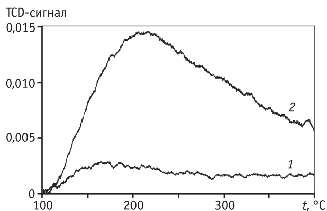
Рис. 5. \text{NH}_3 -ТПД спектр для массивного карбида молибдена (1) и нанесенного карбидсодержащего катализатора (2), полученных методом механической активации
