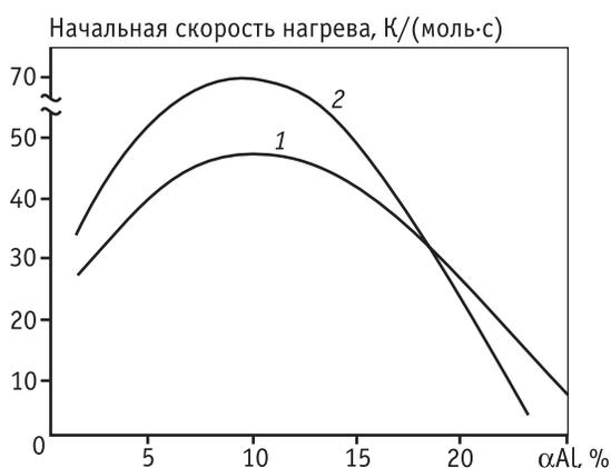
**Рис. 3.** Зависимость начальной скорости нагрева образцов композиций  $Al/Al(OH)_3 \cdot nH_2O$  после стадии сушки от степени превращения кристаллитов  $Al$  при гидротермальной обработке
