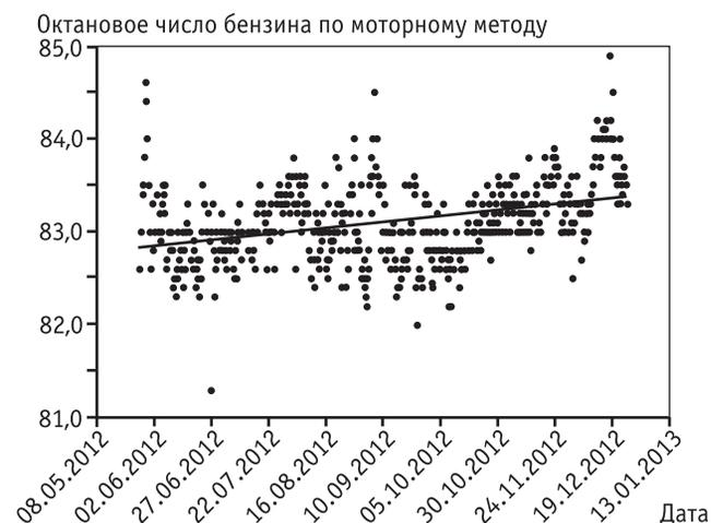
**Рис. 6.** Динамика изменения октанового числа по моторному методу на установке Г-43-107М/1 Уфимского НПЗ в 2012 г.
