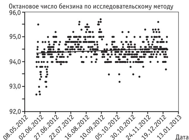
**Рис. 7.** Динамика изменения октанового числа по исследовательскому методу на установке Г-43-107М/1 Уфимского НПЗ в 2012 г.
