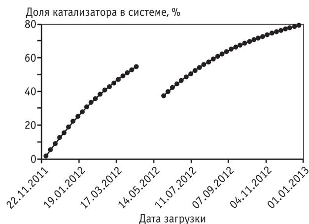
Рис. 4. Динамика изменения содержания катализатора «Октифайн-480П» в системе установки Г-43-107М/1 Уфимского НПЗ
