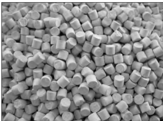
Рис. 3. Гранулированный катализатор крекинга серии «Адамант»
