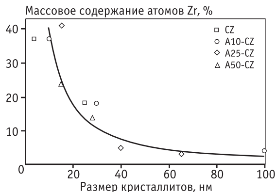
Рис. 6. Зависимость массового содержания атомов Zr в кристаллитах Ce_xZr_{1-x}O_{2-\delta} от их размера
