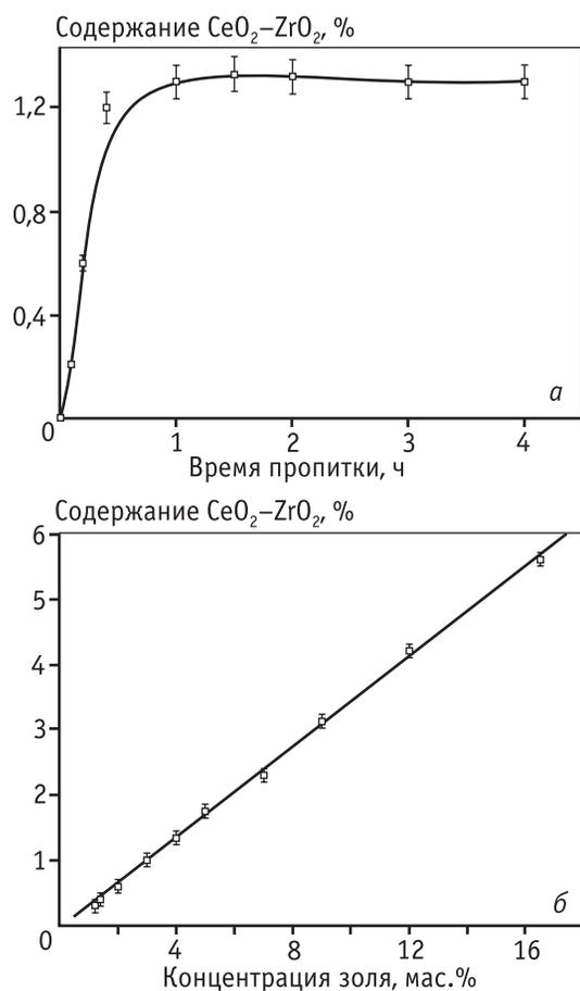
**Рис. 1.** Зависимость содержания  $\text{CeO}_2\text{-ZrO}_2$  в катализаторе: а – от времени пропитки (концентрация золя  $\text{CeO}_2/\text{ZrO}_2 = 1/1$  составляла 4 мас.%); б – от концентрации золя ( $\text{CeO}_2/\text{ZrO}_2 = 1/1$ )
