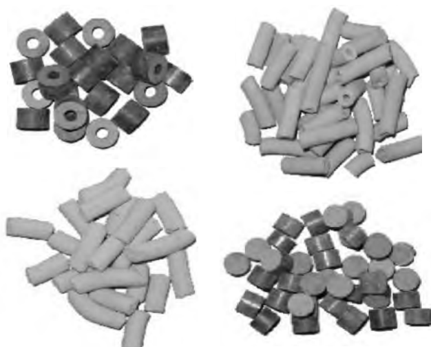
Рис. 1. Геометрические формы катализатора метанирования марки НИАП-07-07 (НКМ-7)
