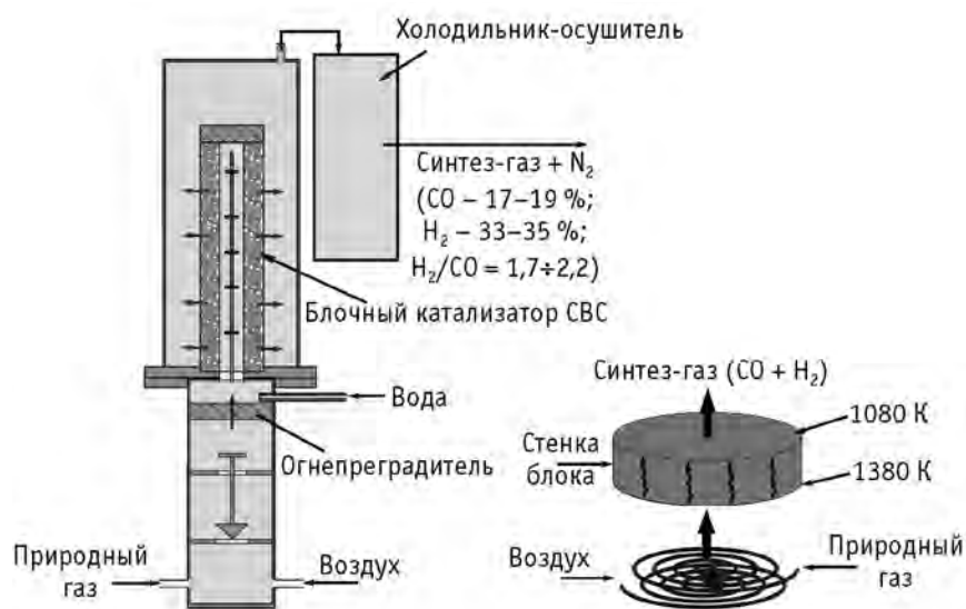
Рис. 3. Схема генерации синтез-газа с использованием блочных СВС-катализаторов в автотермическом режиме
