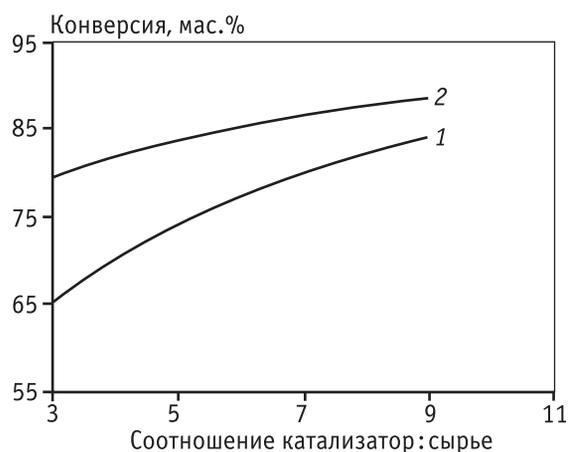
**Рис. 1.** Влияние соотношения катализатор:сырье на конверсию вакуумного газойля на катализаторах бицеолитном (1) и ЛЮКС (2) при температуре 540 °С
