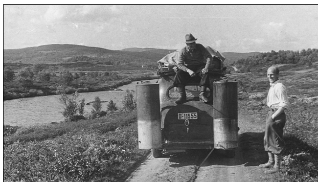
Рис. 1. Автомобиль с газогенераторным двигателем – применение биомассы в качестве моторного топлива – в годы второй мировой войны (архив проф. А. Холмена, Тронхейм, Норвегия)
