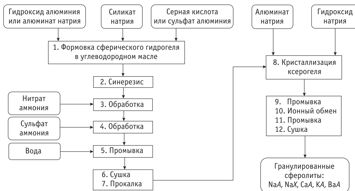
Рис. 1. Синтез из аморфных алюмосиликатов шариковых цеолитов NaA и NaX без связующих [17]
