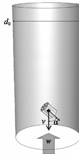
Рис. 3. Свободное падение частиц катализатора ( g = 9,8 \text{ м/с}^2 ) при загрузке труб трубчатого реактора. Диаметр трубы d_0 = 96 \text{ мм} . Исследованный диапазон скорости 1,0 \leq w_0 \leq 30,0 \text{ м/с} , w_0 = (v - w) . Угол атаки частицы \alpha = 0, 45 и 90 град. Среда – воздух при нормальных условиях. Диаметр частиц d = 13,3 и 16,3 \text{ мм} , длина l = 17,0 и 20,1 \text{ мм}
