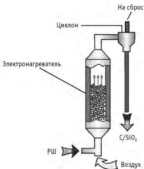
Рис. 1. Схема процесса карбонизации рисовой шелухи (РШ) в реакторе с кипящим слоем катализатора
