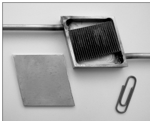
Рис. 1. Микрореактор с МК-пластинами для получения водорода в процессе паровой конверсии метанола
