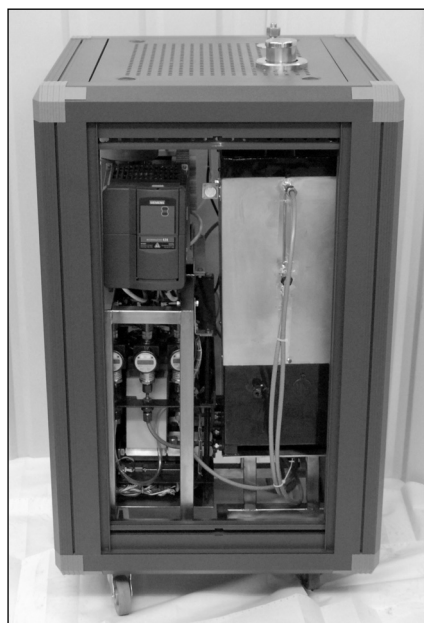
Рис. 3. Топливный процессор получения синтез-газа на базе микроканального реактора для питания топливного элемента электрической мощности 2 кВт
