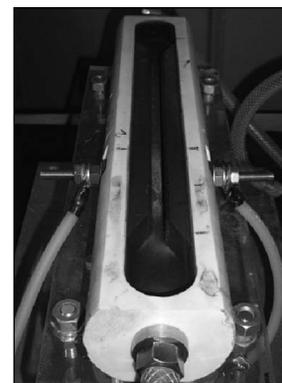
Рис. 2. Реактор с продольным протоком жидкости со снятой верхней крышкой
