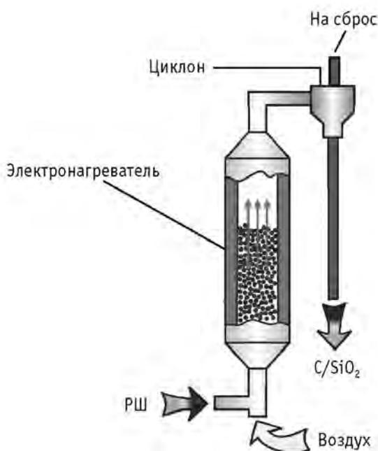
**Рис. 1.** Схема процесса карбонизации рисовой шелухи (РШ) в реакторе с кипящим слоем катализатора
